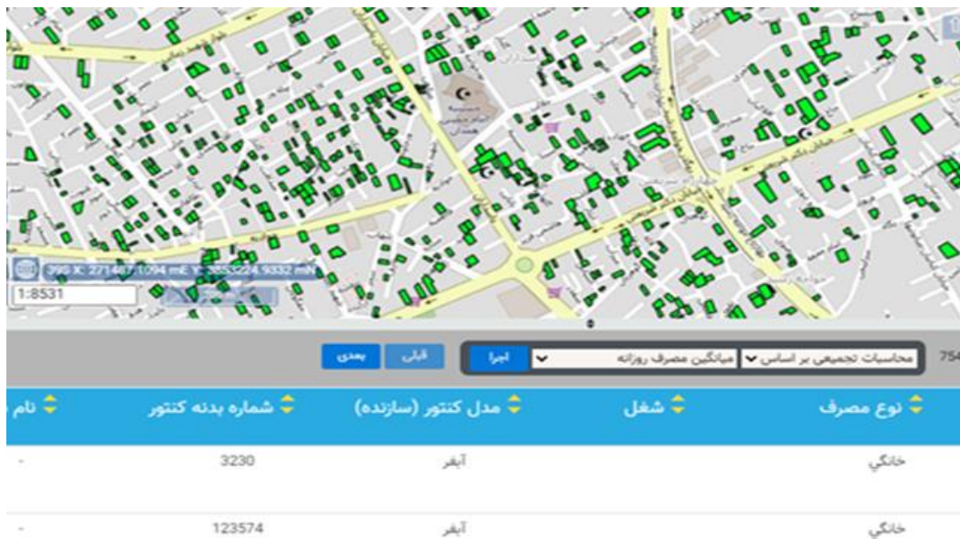
شکل ۷: شناسایی مشترکین کم مصرف خانگی با کنتور مدل آبفر در سیستم GIS
